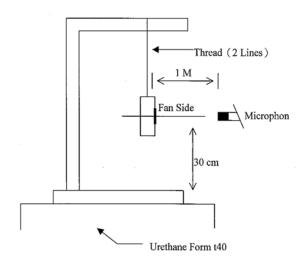
1 METER FROM MICROPHONE TO FAN INTAKE
