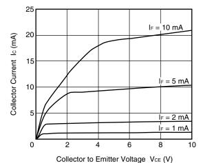
COLLECTOR CURRENT vs. COLLECTOR SATURATION VOLTAGE
